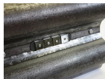
Membranwandsensor zur Korrosionsmessung im Verdampferbereich
