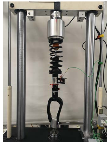
Bild 1: Federbein in der servo-hydraulischen Prüfmaschine
