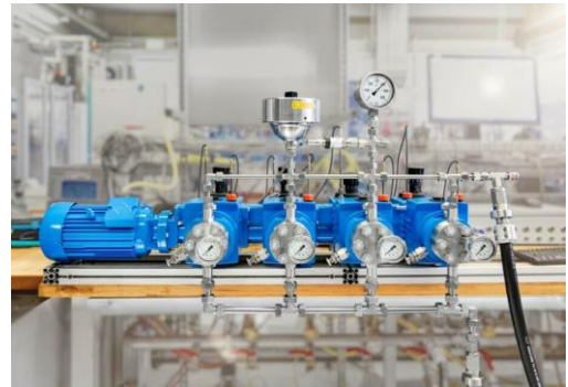
Bild 1: Prozesspumpe im Prüffeld [Lewa]
