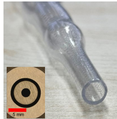
Hohlstruktur, mittels Koaxialdüse hergestellt, mit Innendruck umgeformt
