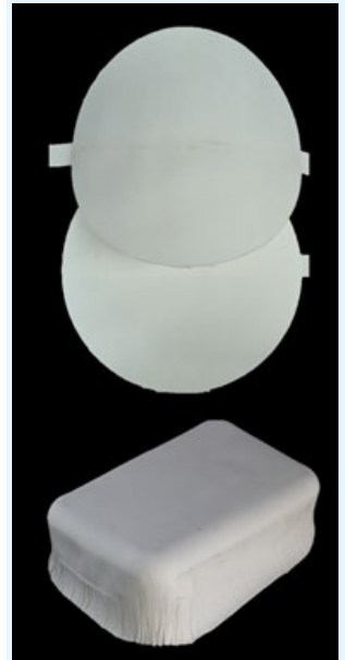
Vorgespannte und nicht vorgespannte Papierprobe, Tiefziehprodukt
