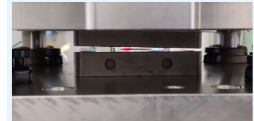
Durch Verkipfung des Stößels hervorgerufene Werkzeugpose
