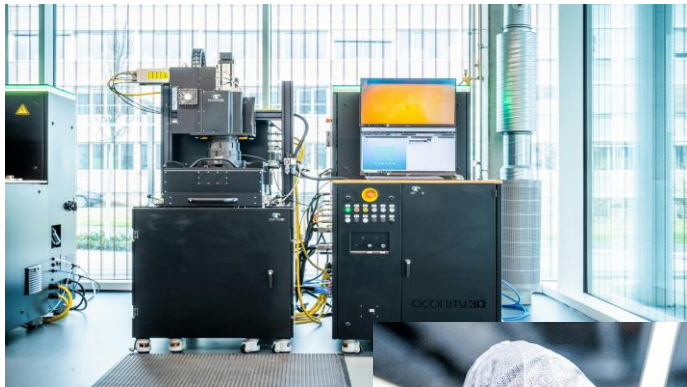
Die Aconity MIDI im AMC (oben), typische Schutzausrüstung im AM-Labor (rechts) (© Jan Hosan)
