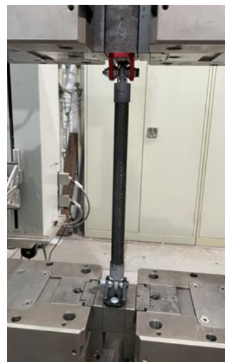
Abb. 1 (links): Zugversuch an einer Carbon-Querlenkerstange ("Rod") mit additiv gefertigten Gelenkkopfhalterungen Abb. 2 (rechts): Fahrwerkskonsolen (Mono Brackets) aus Carbon - vor dem Erprobungsversuch, links - nach dem Erprobungsversuch, rechts
