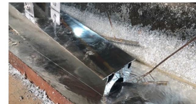
Abb. 2: Versuchsträger während des Herausziehens aus dem Zinkkessel
