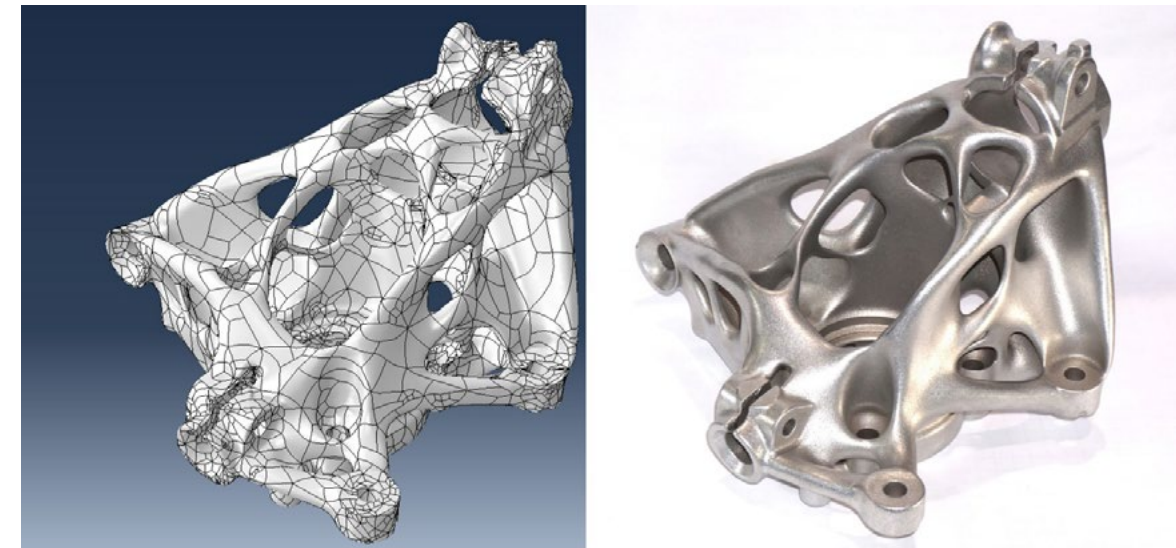
Abb. 2: Radträger: FE-Modell zur Validierung des entwickelten konstitutiven Materialmodells (links); aus hochfester Aluminiumlegierung Al2139 im LPFB-Verfahren additiv gefertigt (rechts)
